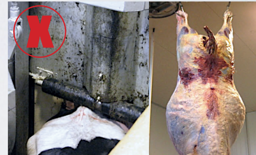
Un rodillo con superficie de goma en la base de las puertas de guillotina es una buena alternativa para amortiguar posibles golpes y sus consecuencias en la canal.
